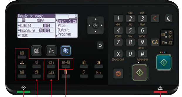
Yeşil LED durum lambası Faks Fonksiyon tuşları Tarayıcı program tuşları Kimlik kopyalama tuşu Kırmızı LED durum lambası
